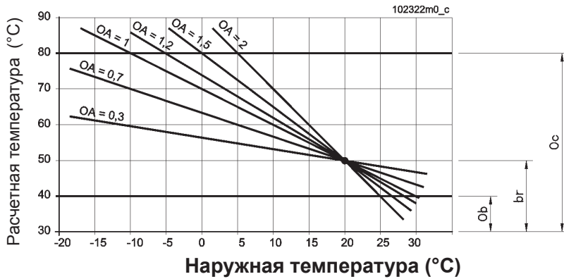
Рисунок 38 -Контур высоких температур. График климатической регулировки (регулировка при изменении параметра “OA”)
