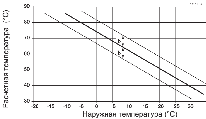
Рисунок 38а - Контур высоких температур. График климатической регулировки (регулировка при изменении параметра “b”)
