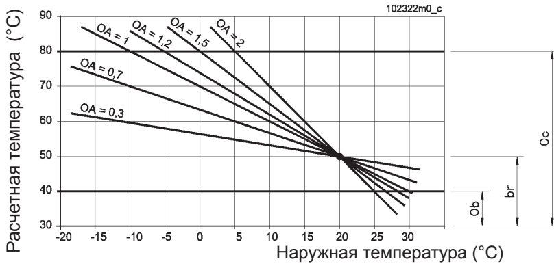
Рисунок 30 - Контур высоких температур. График климатической регулировки (регулировка при изменении параметра "OA")
